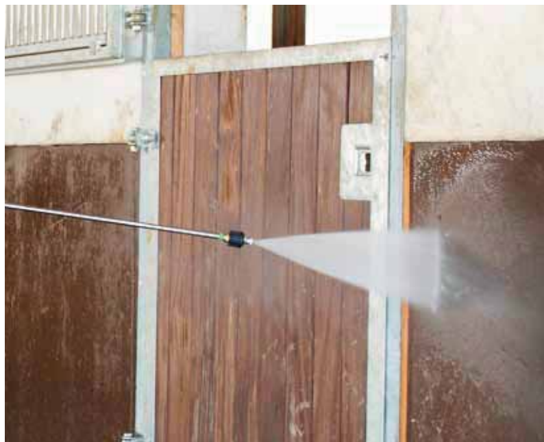
Ábra: Sugárcső szabályozó fúvókával
