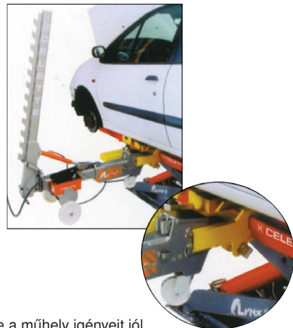
3. ábra: Lynx II a legegyszerűbb, de a műhely igényeit jól kielégítő karosszériajavító pad
