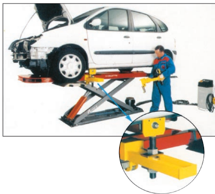
3. ábra: Lynx II a legegyszerűbb, de a műhely igényeit jól kielégítő karosszériajavító pad
