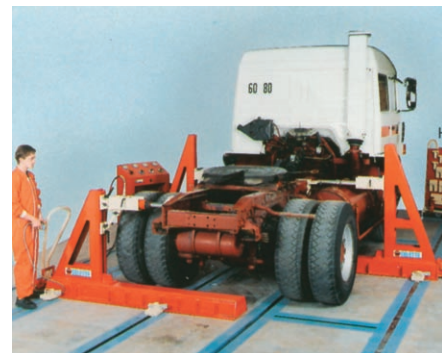
6. ábra: alvázegyengetés a BPL 540 berendezéssel
