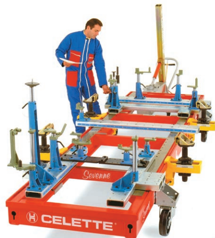
1. ábra: MZ-csapos mérőrendszer a Seyenne padra felszerelve
