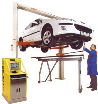
2. ábra: Naja elektronikus mérőrendszer alkalmazása
