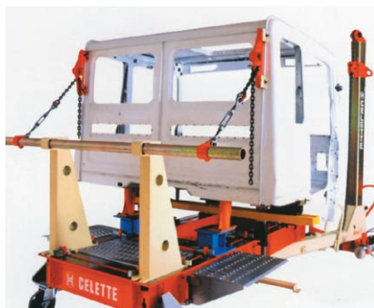
5. ábra: vezetőfülke egyengetése a Menyr jelű padon
